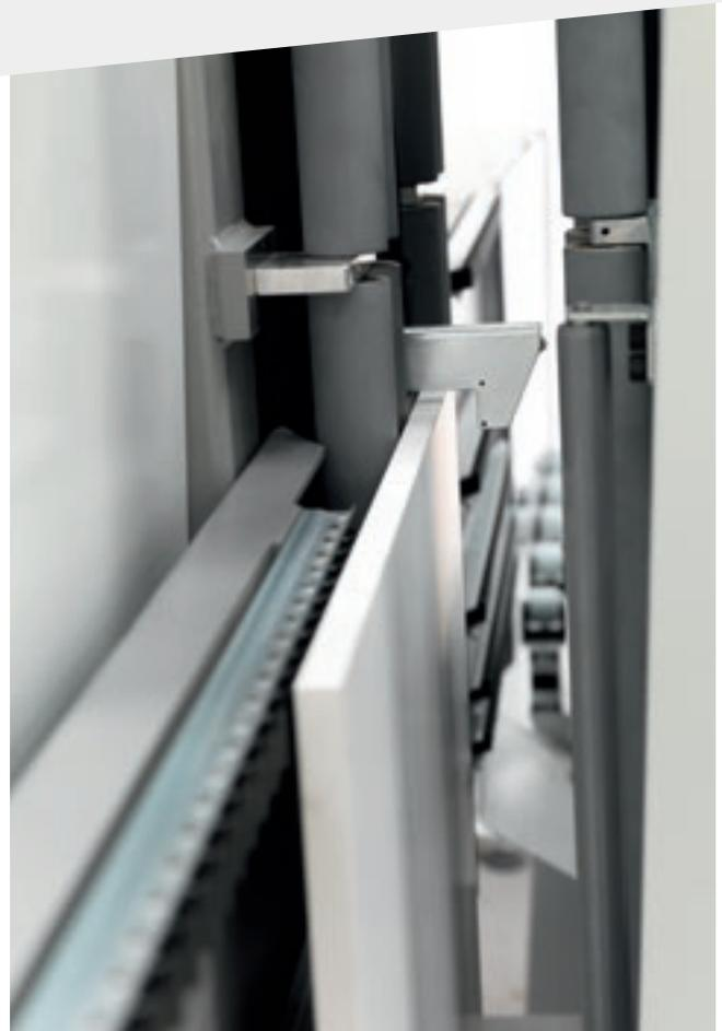
上传感器系统由两个光眼组成，可以检测板材的高度并纠正相对于“Y”轴的尺寸。
